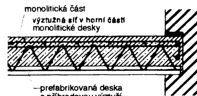
hladký spodní povrch prefabrikované drsný povrch pro smykové spolupůsobení
