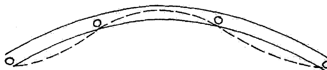
Obr. 9.14. Vybočení členěného prutu k nehmotné ose.
