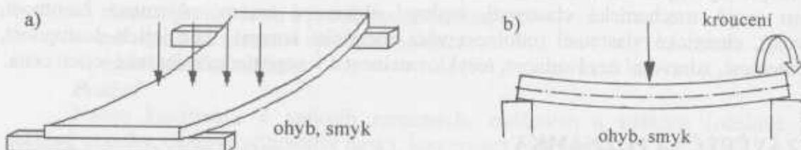
Obr. 3.1 Různé způsoby namáhání desky (a) a nosníku (b).
