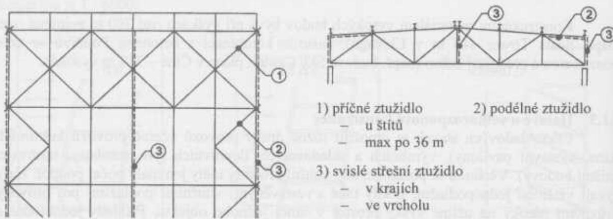
Obr. 2.8 Příklad umístění ztužidel na ocelové střešní konstrukci.
