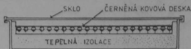
Obr. B.10.1 Deskový kapalinový kolektor
