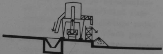
Vykládání vagonů pomocí pojezdného ko- rečkového vykladače
